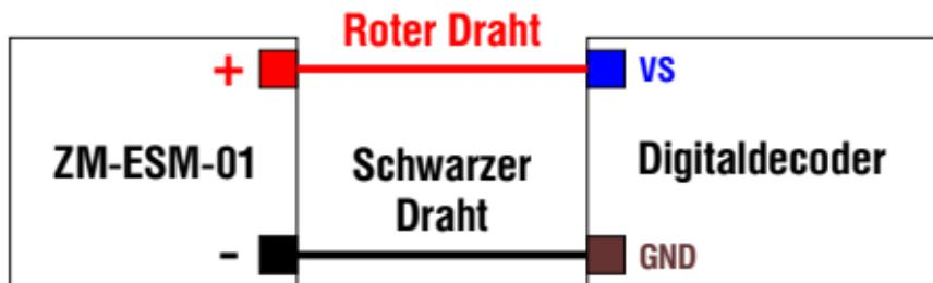
Das schwarze Kabel GND (-), das vom Energiespeichermodul kommt, sollte mit dem GND-Pad des Digitaldecoders verbunden werden (ansonsten als "Masse" oder "OV" bezeichnet).
